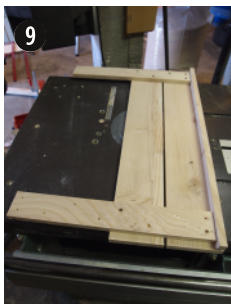
Collage et vissage du dessus.
