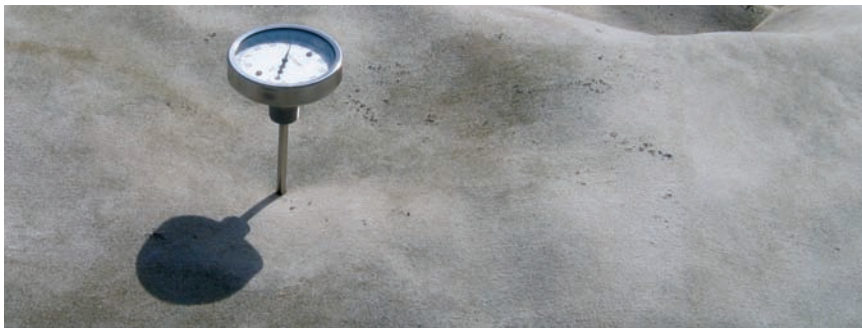
Le thermomètre doit être suffisamment long pour que son extrémité atteigne le centre du tas.
