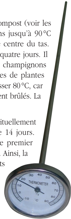
Le thermomètre utilisé doit être gradué au moins jusqu'à 90°C.
